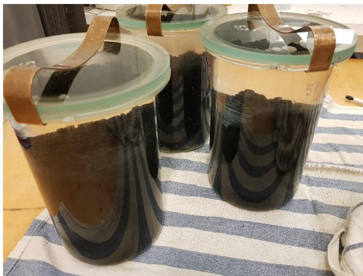
Figur 21. Till vänster standardens förslag. Till höger raka glaspyknometrar med platt lock (här med asfalt). Foto Håkan Arvidsson, VTI.
