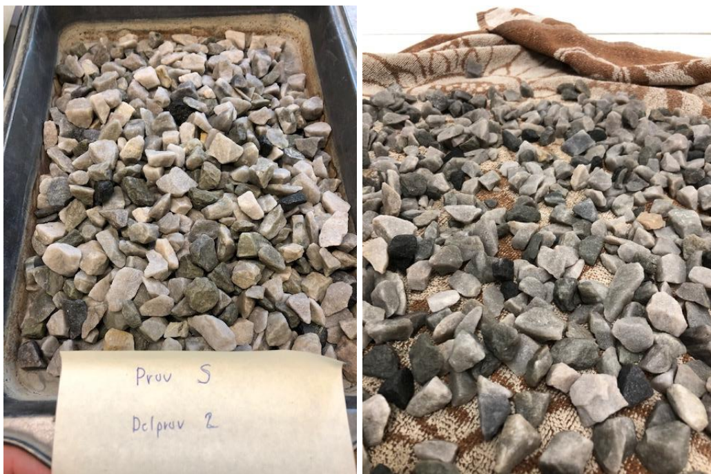
Figur 26. Yttorrät men fuktigt material S. Foton: Amanda Nejman, Skanska och Helen Sälling, Peabasfalt.
