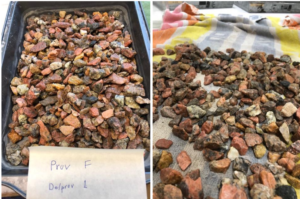
Figur 25. Yttorrät men fuktigt material F. Foton: Amanda Nejman, Skanska och Helen Sälling, Peabasfalt.
